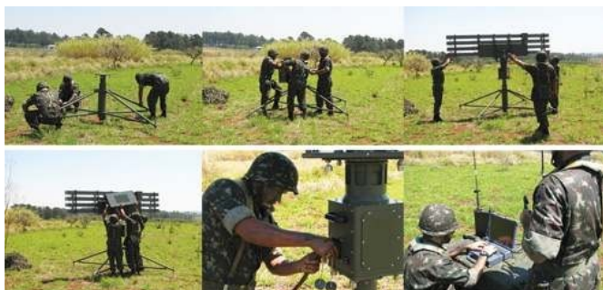
Figura 7 – Montagem do Radar Transportável SABER-M60 Fonte: BRADAR, 2015.
