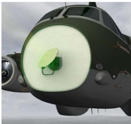
Figura 9 – Localização do Radar Gabbiano T20 no KC-390 Fonte: FAB, 2015.
