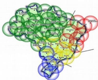
(a) Cobertura de Radares no Brasil (b) Cobertura do Radar Primário Figura 2 – Sistema de Vigilância de Aeronaves Fonte: Adaptado da FAB, 2015b.
